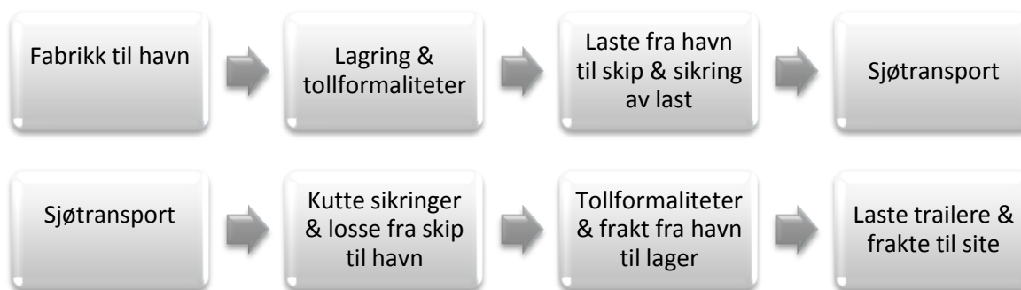
Figur 5.1. Transportkjeden for transport av vindmøller
