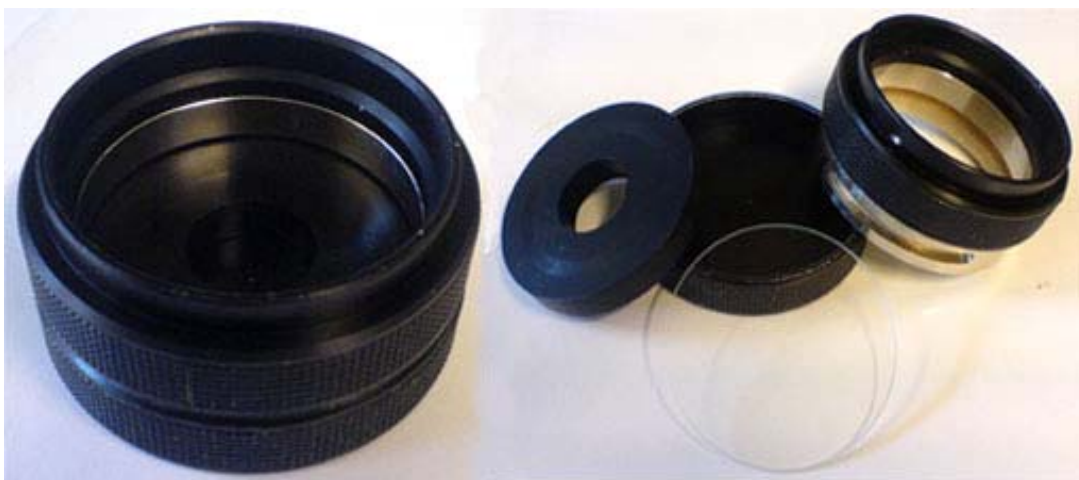
Figur 2.6 Lystett kammer som ble brukt under fargemålingene. Kammeret ble fylt med gonademasse og Minolta Chromameteret CR-300 ble brukt til å måle fargen.
