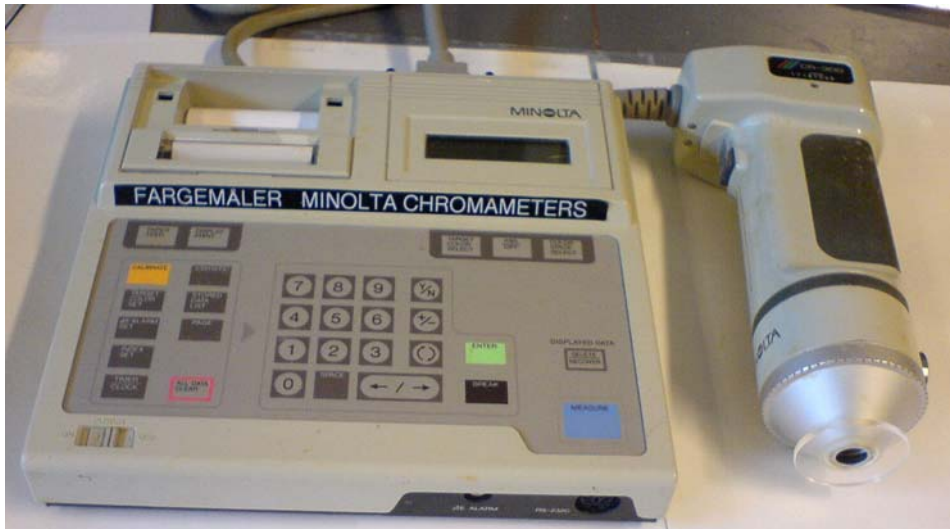
Figur 2.5 Fargemåleren Minolta Chromameter CR-300 som ble brukt for spektrofotometrisk fargemåling av kråkebollejonadene.
