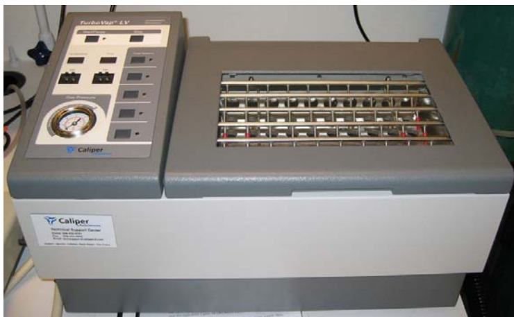
Figur 2.11 Inndamperen TurboVap ® LV evaporator som ble brukt for å dampe av mindre mengder løsemiddel (< 3ml) fra ekstraktet etter ekstraksjon av karotenoider.
