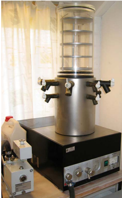
Figur 2.9 Frysetørkeren Hetosicc CD 2,5 som ble brukt for å frysetørke gonadeprovne fra kråkebollene.
