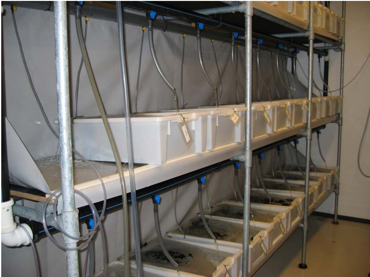
Figur 2.3 Oppsett av kassene i stativet for fôringsforsøket. Hver kasse har egen lufttilførsel via luftstein og egen vanntilførsel.
