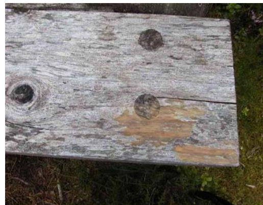
Figur 11. Sitteplanke på benk, ca. 15 – 20 år. Overflaten er grå, men like under er veden frisk.
