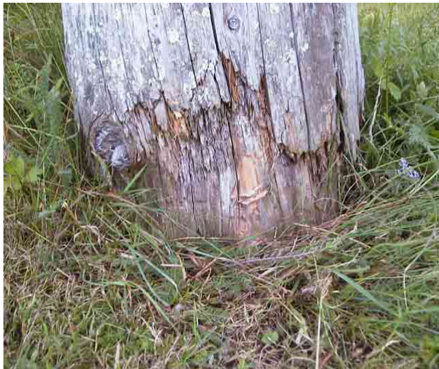
Figur 14. Stolpe, ca. 30 cm i diameter, har stått nedgravd i sandjord i 24 år. Yteveden er borte nede ved bakken, men kjerneveden er intakt
