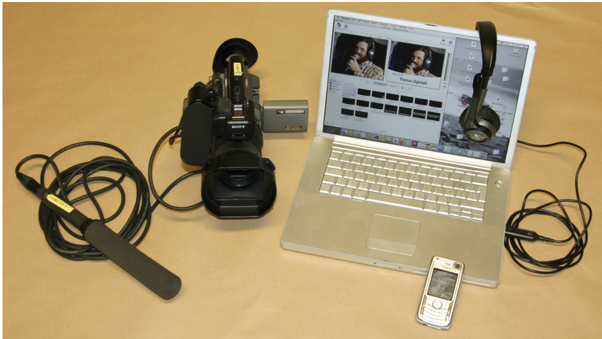
Figur 14: Minimumsløsning (mikrofon, kamera, laptop med Wirecast, headsett, 3G-modem)
