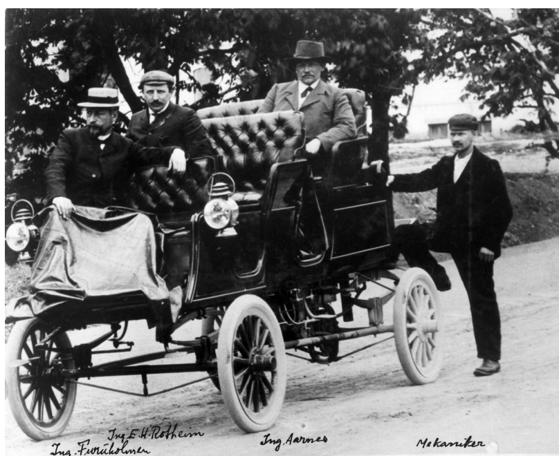
Denne store dampvognen leverte Hiorth til ing. Furuholmen, Askim. I henhold til billedteksten var dette en «Dampmaskin for Bensinfyring», altså en løsning som kombinerte bensin og damp som drivstoff. (Bildet er hentet fra Erling Hiorths album, nå eid av Stein Tranvik, Tiller).
