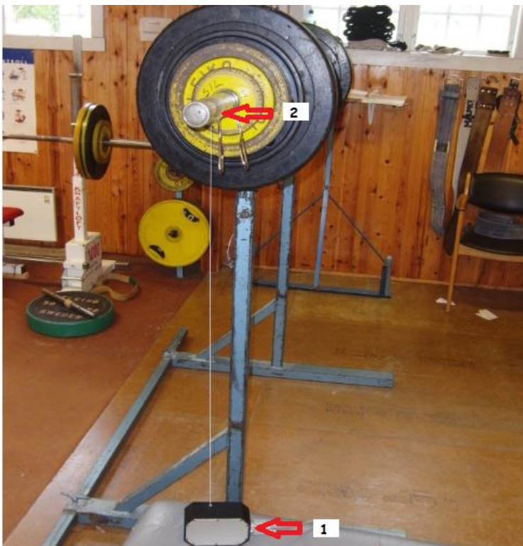
Figur 2: Snora fra encodern (1) er festet til vektstanga (2).
