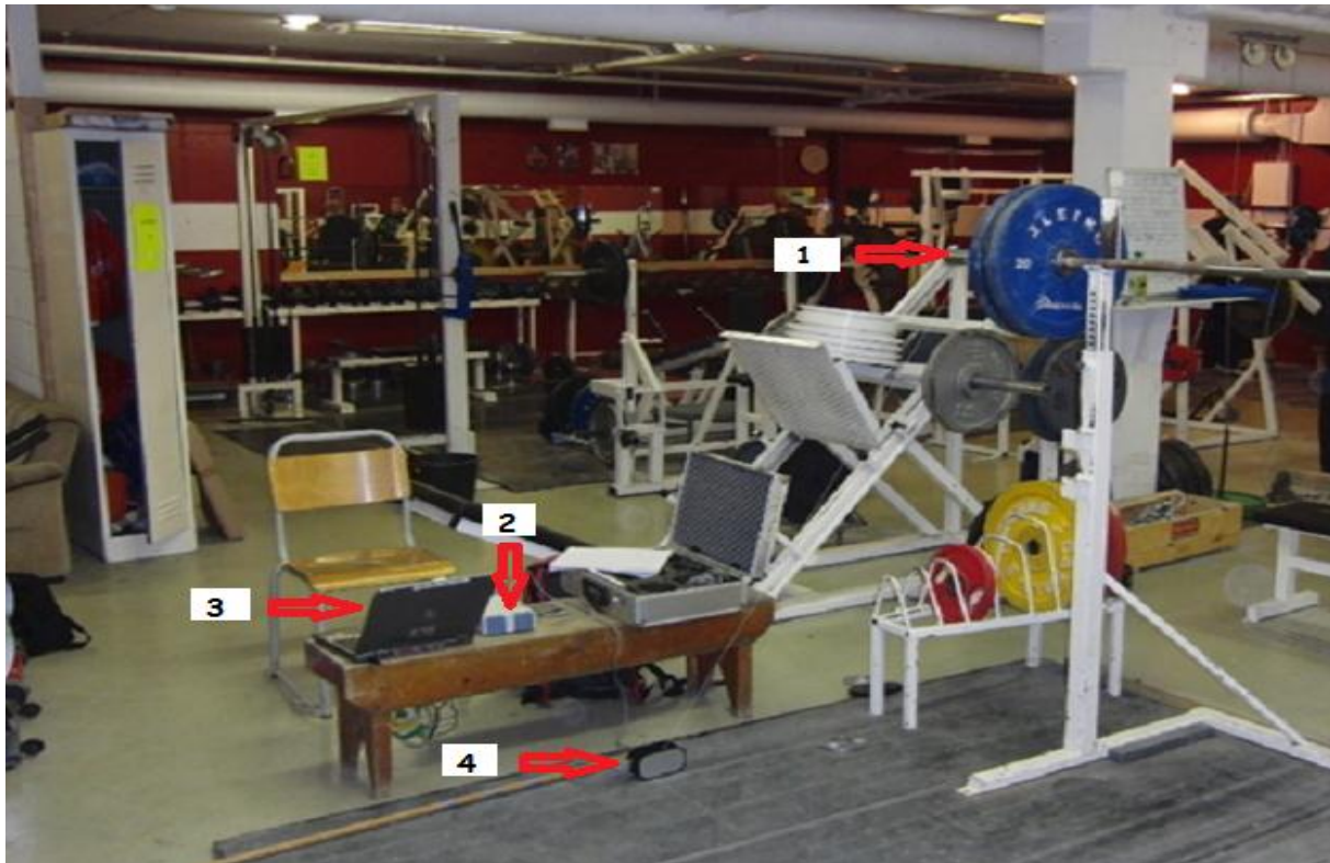
Figur 3: Oversikt over teststasjonen. Snora fra encoderen festet til stanga (1). Konverter (2). Bærbar PC (3). Lineær encoder (4).
