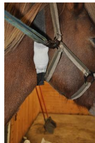
Figur 11, Pulsregistrator festet til transponderhalsbåndet.
