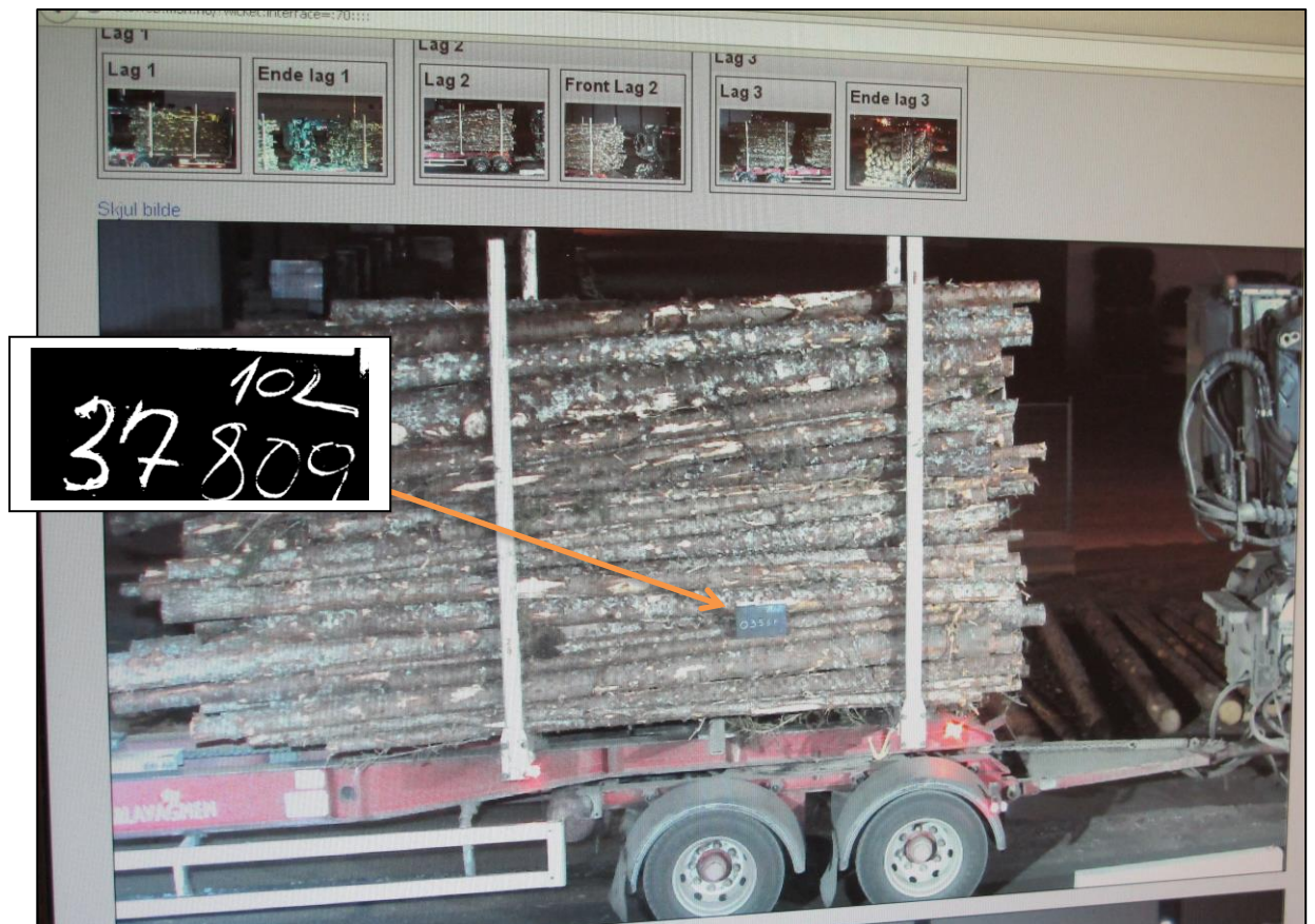
Fotografi av skjerm bilde av en bunt (lag) som er fotomålt. Øverst er vises samtlige bilder som er tatt i denne målinga. Lag = tømmerbunt. Pilen viser en tavle med leverandørnummer. Foto AK
