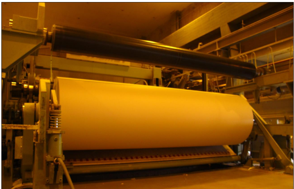
Ved enden av denne tørkeprosessen blir papiret lagret i svære ruller som deretter kappes opp til den størrelsen som kunden skal ha for sin avisproduksjon. Foto: AK
