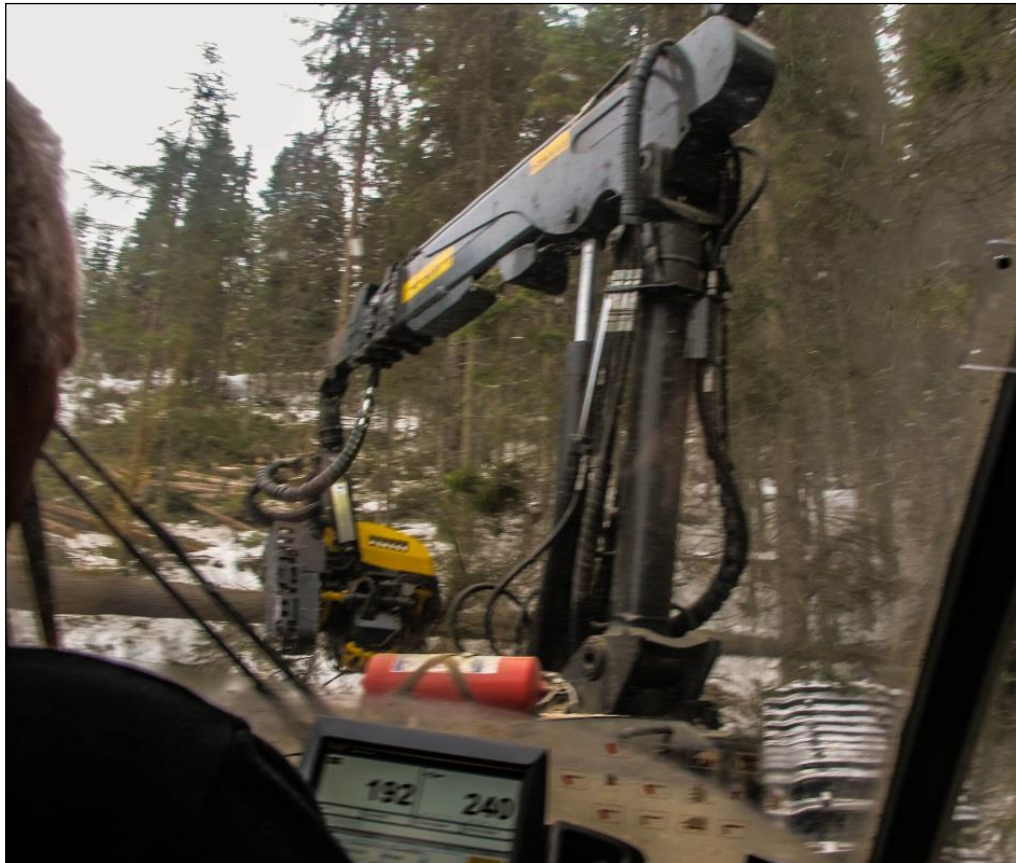
I hogstmaskinen har sjåføren god oversikt og produksjonen kontrolleres og registreres av datasystemet. Hver enkelt stokk blir kappet i forhold til mulige skader, lengde, avsmalning, pris og volum. Foto: AK
