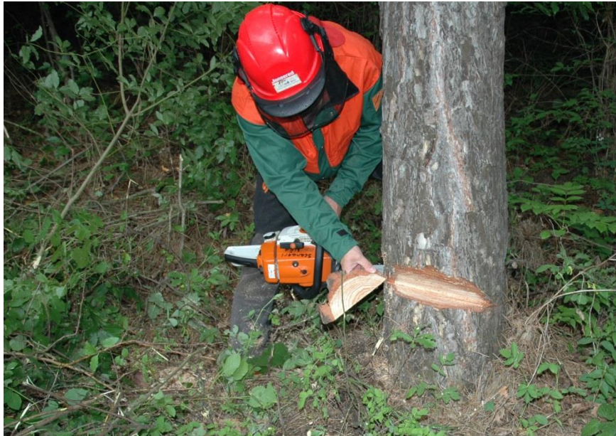
Det første skjæret er gjort og skogsarbeideren har bestemt hvilke retning treet skal falle. Foto: AK
