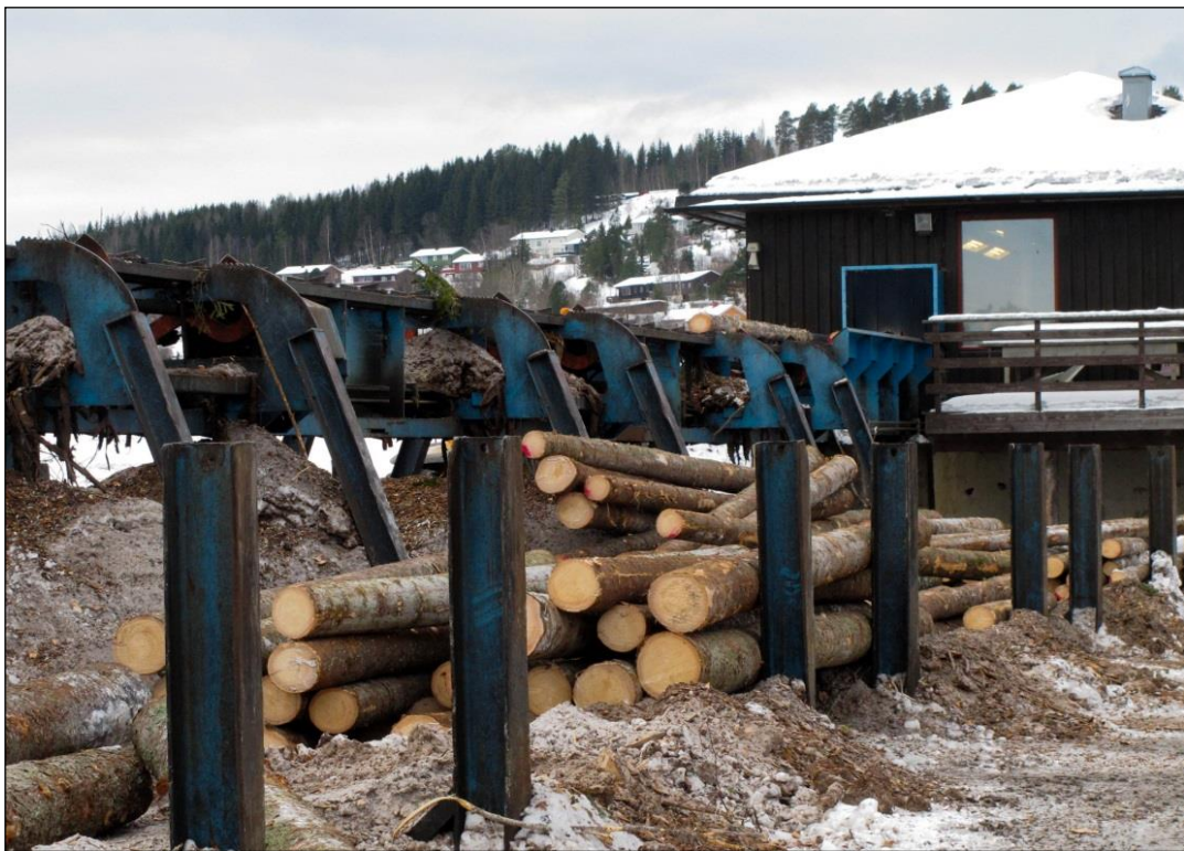
På dette sagbruket , Inn-Tre AS i Steinkjer blir de forskjellige dimensjonene av tømmeret sortert i lommer slik at mange stkker av samme dimensjoner kan tas inn på saga samtidig. Det finnes mange forskjellige måter å gjøre dette på. Foto: AK
