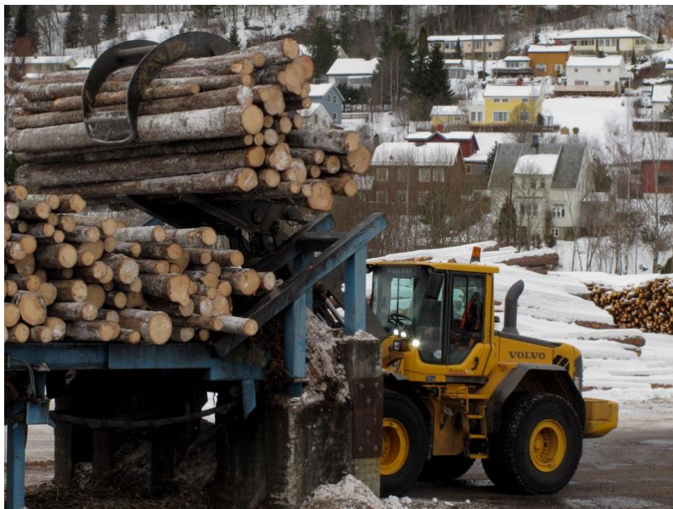
Når tømmeret er losset på sagbruket blir det lagt inn på transportbånd for måling og sortering før det blir produsert trelast. Foto: AK
