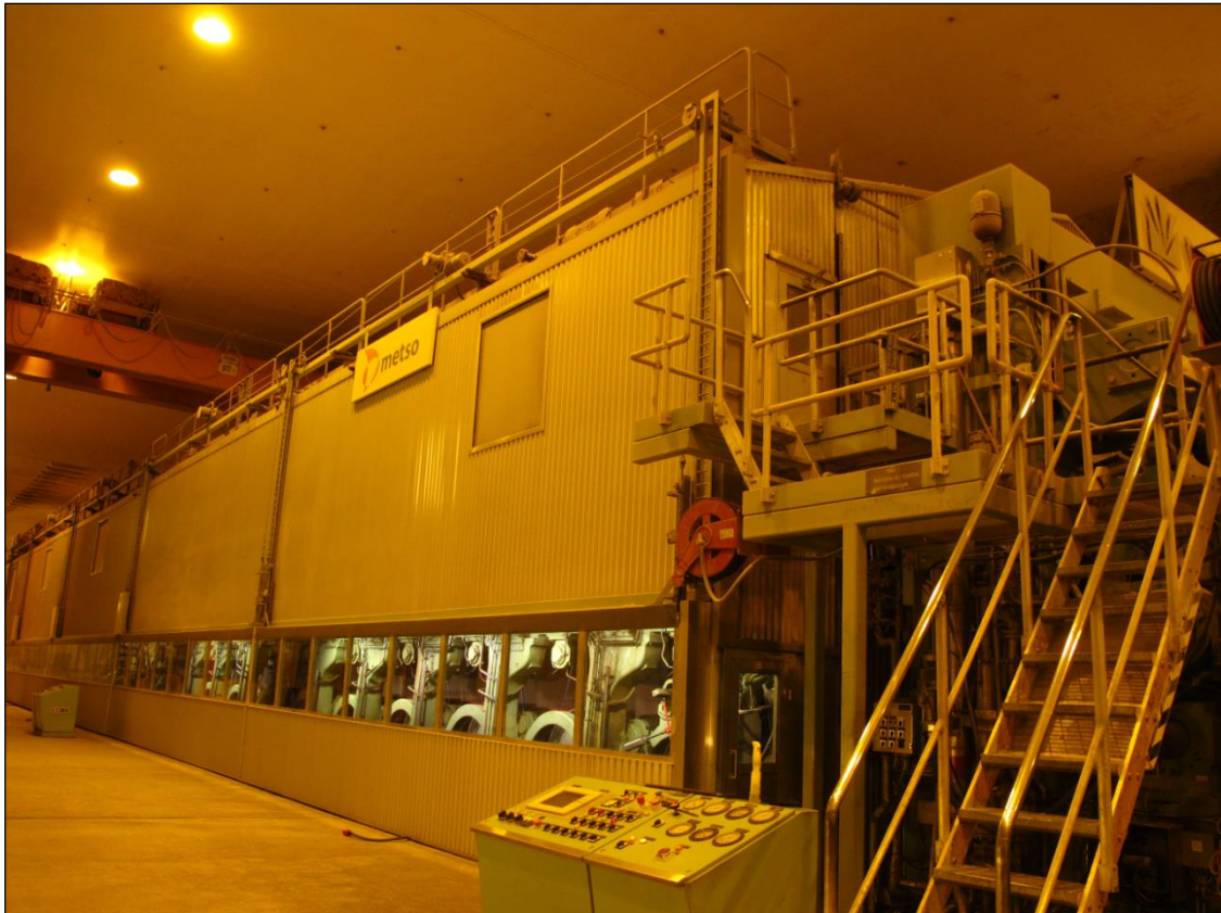
I papirmaskinen som her lager avisepapir, blir tremassen fordelt ut på en endeløs metallduk og gjennom en lang serie med gradvis pressing og tørring kommer papiret ut med et fuktighetsinnhold på 9% vann. Foto: AK
