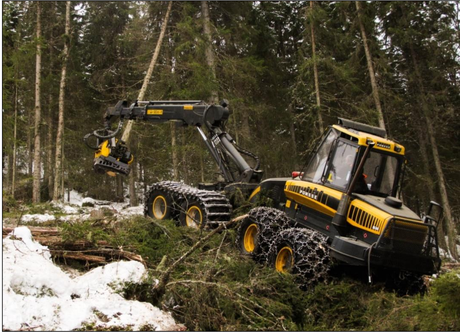
Hogstmaskinen et svært terrenggående. Hogsten gjøres trygt og med riktig kapping av tømmerstokkene i forhold til kvalitet og gjeldende priser. De forskjellige tømmerstokkene blir fargemerket. Foto: AK
