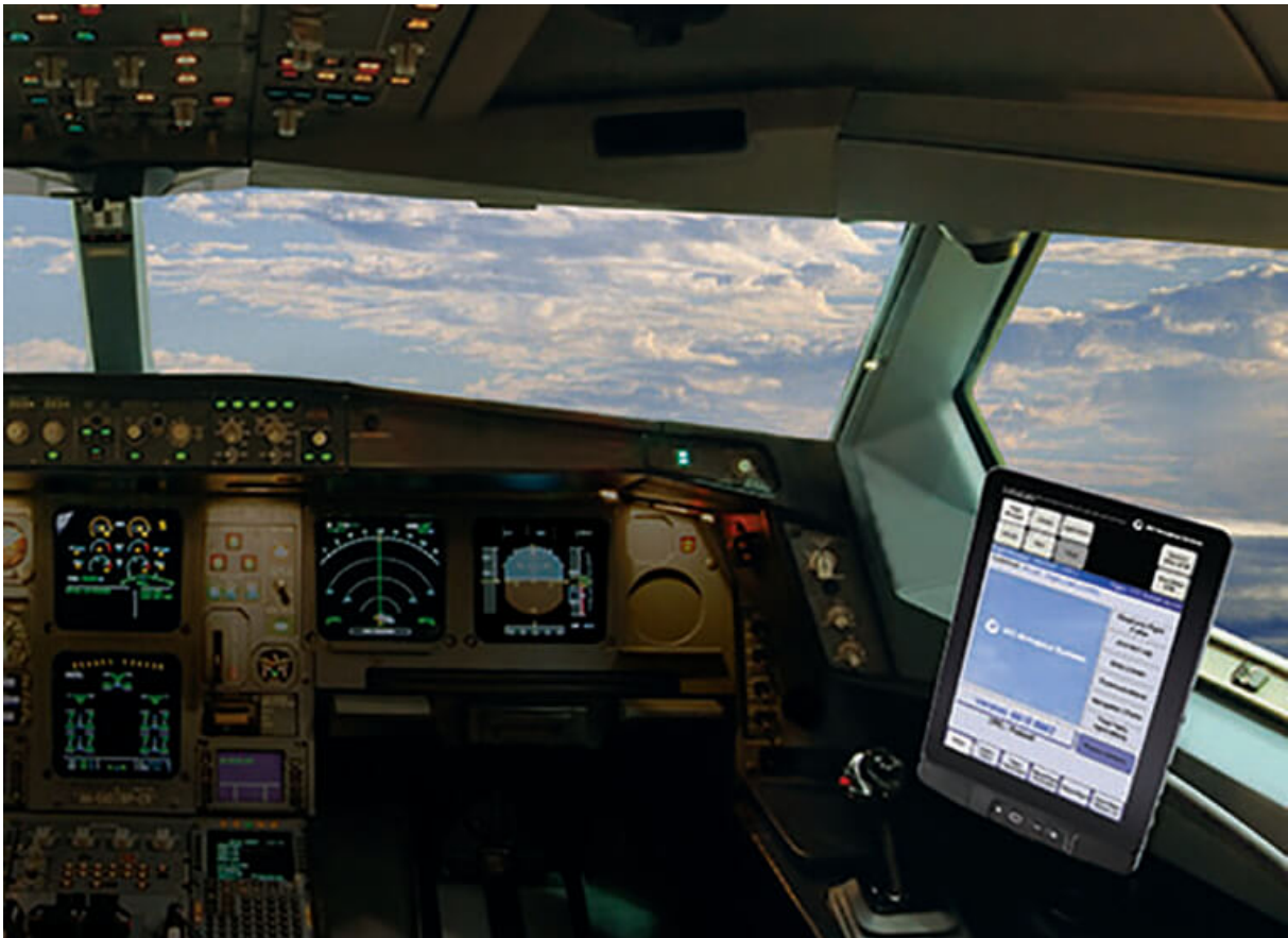
Bilde 1 – Rockwell Collins EFB (skjerm til høyre på bildet)
