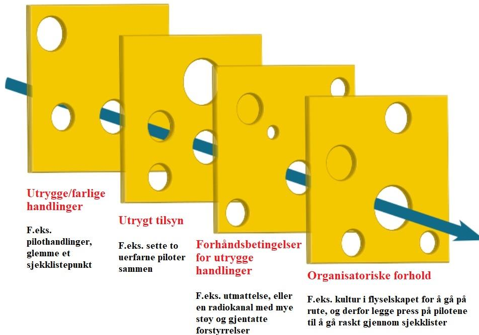
Figur 2: Sveitserostmodellen, operasjonalisert ved bruk av HFACS, av Flight Safety Australia, 2016 ( https://www.flightsafetyaustralia.com/2016/09/safety-in-mind-swiss-cheese-and-bowties/ ). Vår oversettelse.
