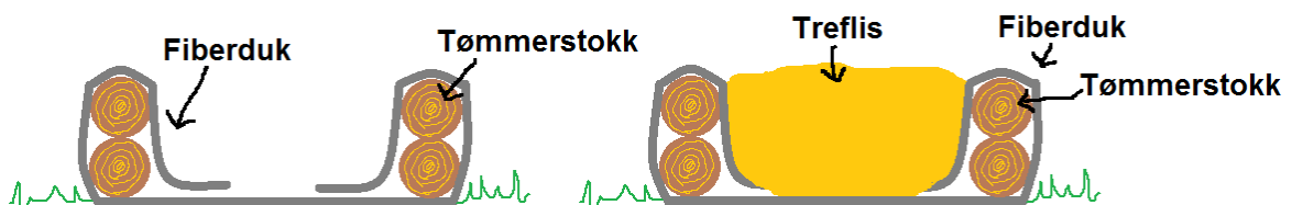
Bilde 39 Illustrasjon av drivgang konstruert med tømmerstokker og fiberduk. Treflisa holder alt på plass på grunn av vekta på flismassen.
