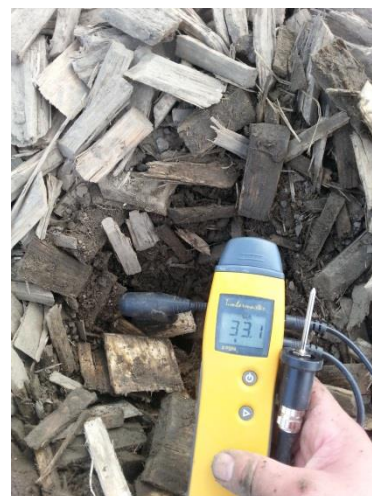
Bilde 15 Fuktighet i flisbiten leses av displayet og noteres i bok
