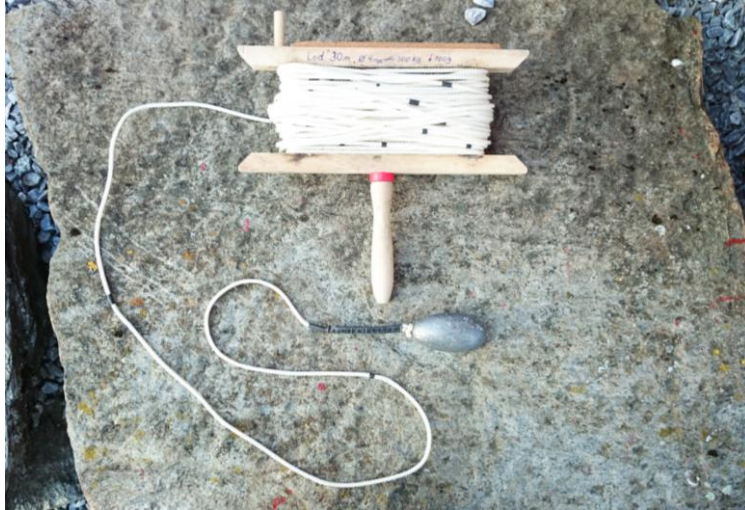
Figur 7: Manuellt djuplod som användes under fältarbetet. På repet sitter svart märkning varje halvmeter med olika stora märken för hel- och halvmeter.
