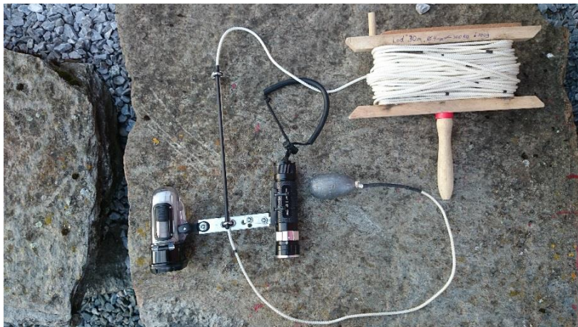
Figur 9: En anordning med kamera och lampa blev monterad på repet till djuplodet.
