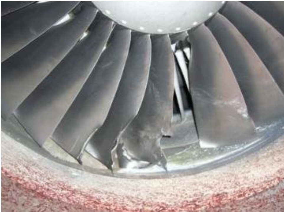
Figur 4.1: Ødelagt motor CRJ-900 København 2009
