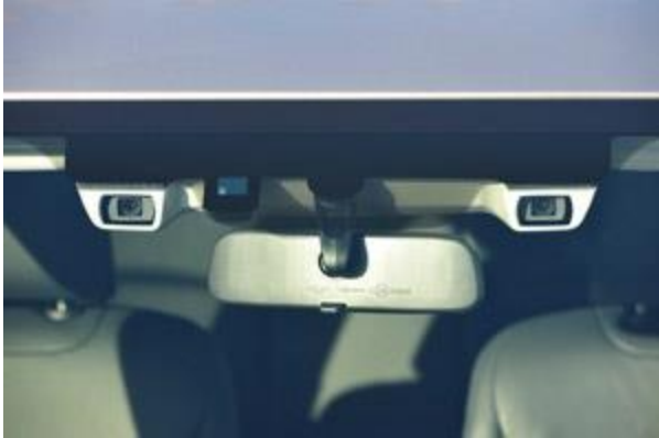
Bilde 7: Subarus plassering av EyeSight. (Subaru Norge AS, u.d.)
