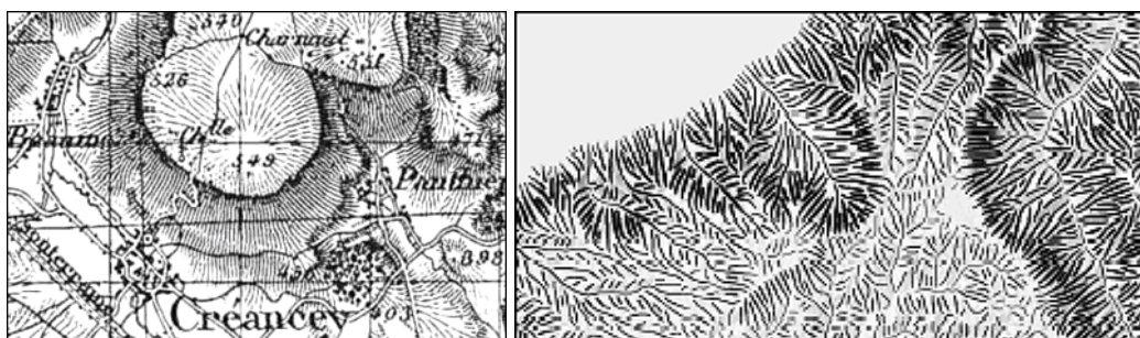
Figur 7-43 To eksempler på bruk av bakkestreker. Det første framstilt analogt i et eldre fransk kart. Det andre framstilt digitalt. Kilde: Kevin Buchin, Design and Implementation of Real-Time Rendering Techniques for the Non-Realistic Illustration of Digital Terrain Models, http://page.mi.fu-berlin.de/~buchin/proj/npr_terrain/ , 2004-03-01.
