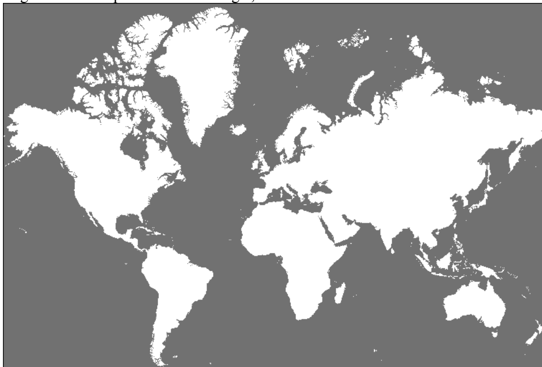
Figur 2-2 Mercators konforme projeksjon er en vinkelriktig rposjeksjon, som har den egenskapen at hvis du trekker en rett strek mellom to punkter i karet, så vil du kunne bevege deg langs denne streken, fra det ene stedet til det andre, med en konstant kompasskurs. Dette gjør kart med denne projeksjonen godt egnet til navigasjon. Områder nær polene blir veldig forstørret i Mercators projeksjon. For eksempel så ser Grønland større ut enn Australia, men i virkeligheten er Australia tre ganger større enn Grønland.
