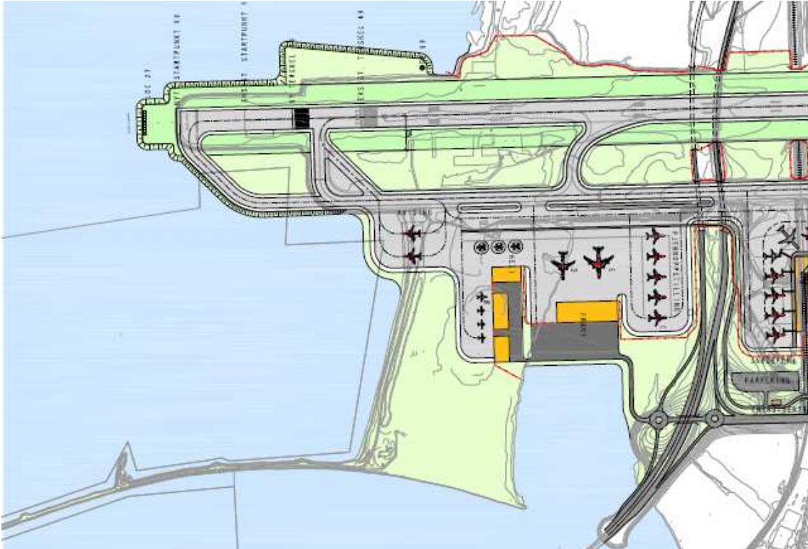
Figur 2.4. Fase 2 i Avinors planer for utvidelsen av Værnes lufthavn på Langøra sør og Sandfærhus. Denne fasen er planlagt gjennomført i 2016-2025.
