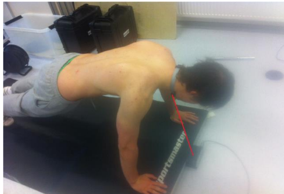
Figur 2. Illustrasjonsbilde av start posisjon i armhevingen. Med en inntegnet beskrivelse av snoren som var festet til halsen fra linear encoder(registrerte hastighet og høydemålinger).
