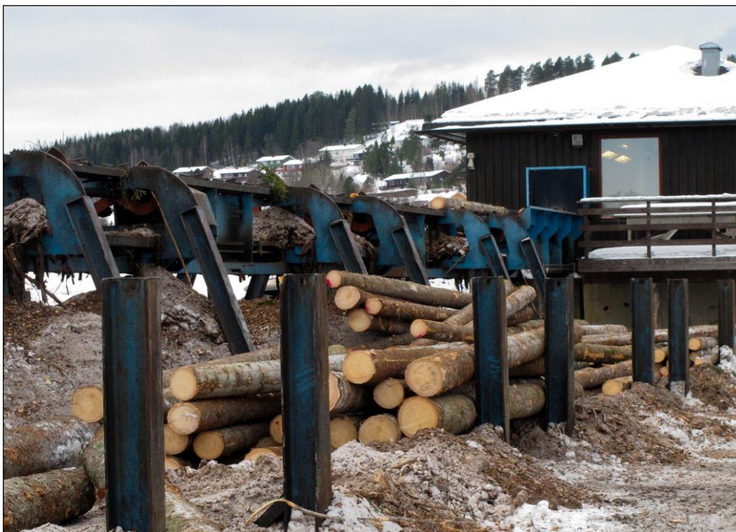
På dette sagbruket , Inn-Tre AS i Steinkjer blir de forskjellige dimensjonene av tømmeret sortert i lommer slik at mange stokker av samme dimensjoner kan tas inn på saga samtidig. Det finnes mange forskjellige måter å gjøre dette på. Foto: AK
