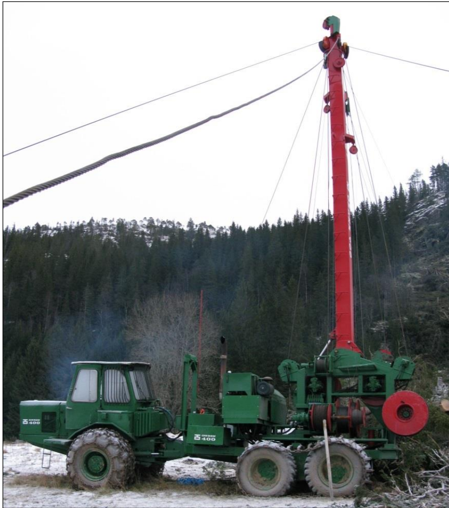
Norskbygget kabelkran Owren 400 montert på en rammestyrtraktor. Den har god framkommelighet slik at den kan plasseres på et hensiktsmessig sted. Foto: Nils Olaf Kyllø
