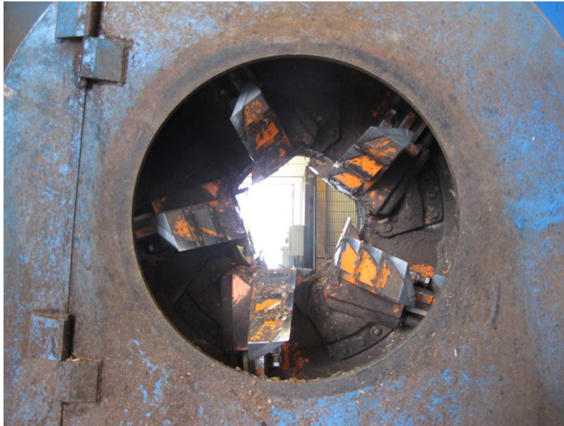
Detalj av barkemaskin for tømmer. Foto: AK
