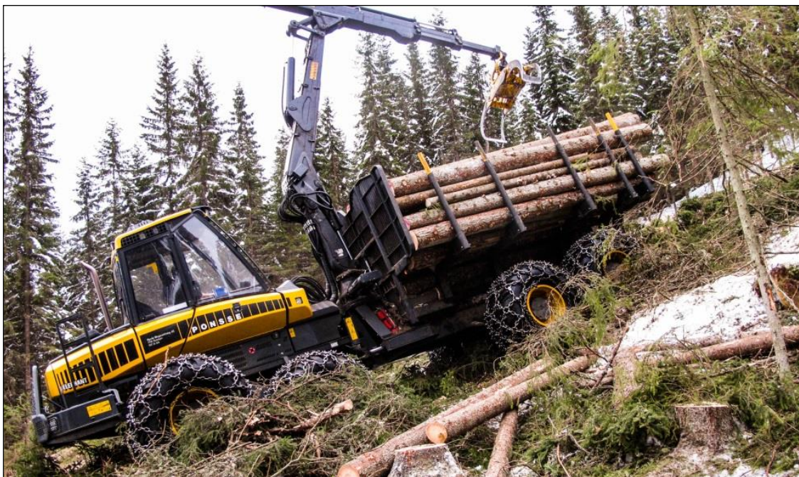
Lastetraktoren har nesten fullt lass. Det er drift på alle 8 hjulene. Foto: AK
