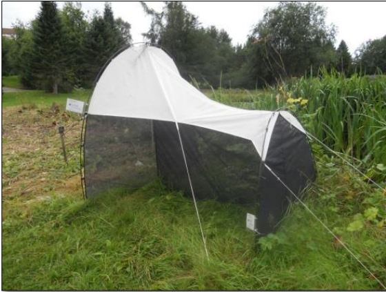
Fig. 2. Malaise-telt er en insektsfelle for innsamling av flyvende insekter. Insekter som setter seg på den mørke nettingen vil kravle oppover, tiltrukket av den lyse duken. Denne duken vil lede dem stadig oppover og ned i en beholder med sprit. Foto: Mona Saurset.
