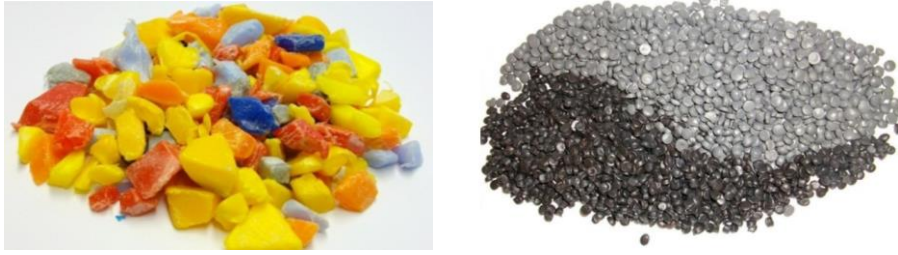
Figur 16: Vaska og oppkappa plastbitar (t.v.) og ferdig granulat til sal for ny produksjon. (Foto: Swerec)
