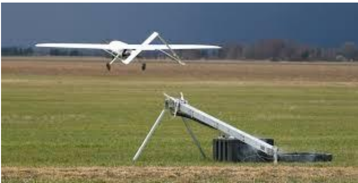
Figur 4. Penguin B er en profesjonell fixed wing RPAS med flygetid på opptil 26 timer med 4 kg nyttelast. (uavfactory, 2015)
