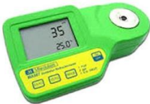
Bilde 1: Digitalt refraktometer, et Milwaukee Brix refraktometer (Dragset & Whist, 2015). Det er dette refraktometeret som ble brukt i vårt feltarbeid.
