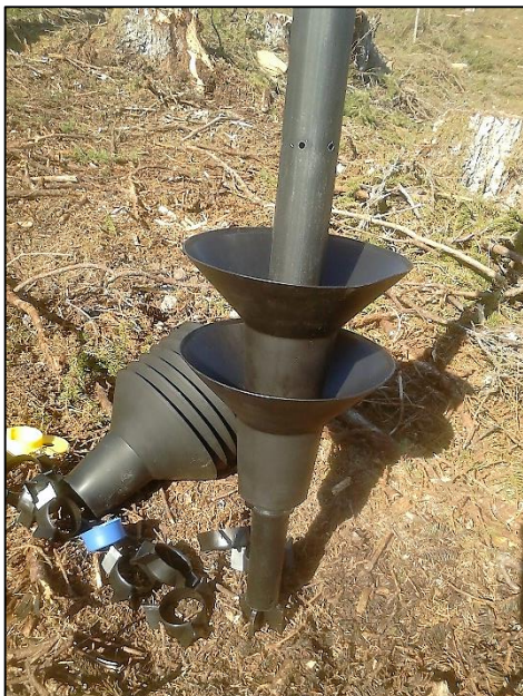
Figur 5. En beka-felle består av trakter, jordspyd, bærestolpe, oppsamlerkopp, silrør, avstandskryss, låseklips, topphette og feromonpose (monteringsbeskrivelse vedlegg E).
